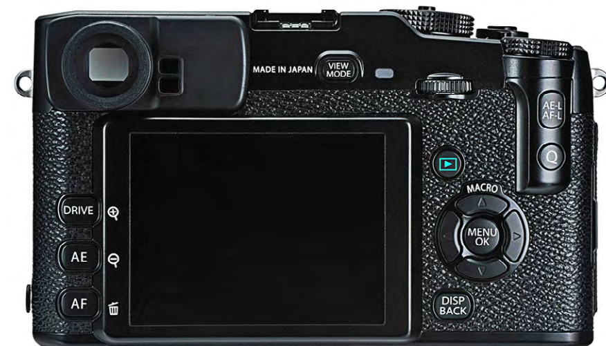
Abb. 1: Die neue FUJIFILM X-Pro1. Der Body ist 14,0 x 8,2 x 4,3 cm groß und wiegt ca. 440 Gramm.
