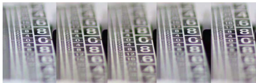
Abb. 4: Dasselbe Objektiv (85 mm f/1,2) auf fünf verschiedenen Exemplaren des gleichen Kameragehäusertyps. Wie Sie sehen, gibt es bei jedem Gehäuse kleine Unterschiede in Bezug auf Frontfokus oder Backfokus.
