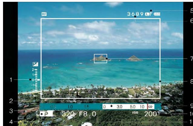
Abb. 15: Links: Blick durch den optischen Sucher (Simulation): Belichtungskorrektur/Belichtungsskala (1), Schärfentiefebalken (2), Verschlusszeit (3), Belichtungsmodus (4), Bildgröße + Qualität (5), Verbleibende Aufnahmen auf der Speicherkarte (6), AF-Feld/ Sucherlupenrahmen (7), Bildrahmen (8), Entfernungsskala (9), ISO-Anzeige (10), Blende (11). Rechts: Blick durch den EVF (Simulation).
