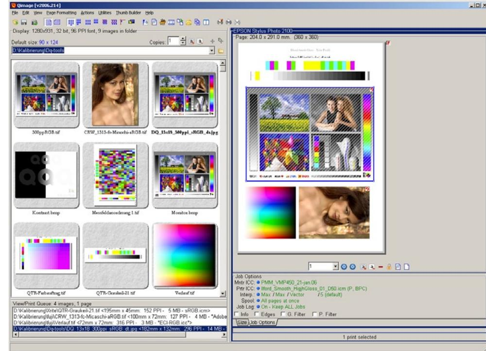
▶ Meine Testseite enthält neben bekannten Testbildern einen 21-stufigen Graukeil im Target-Format des Pulse sowie einen Farbverlauf. Die für diese Testseite benutzten Einstellungen speichere ich als Druckereinstellung in Qimage ab.
