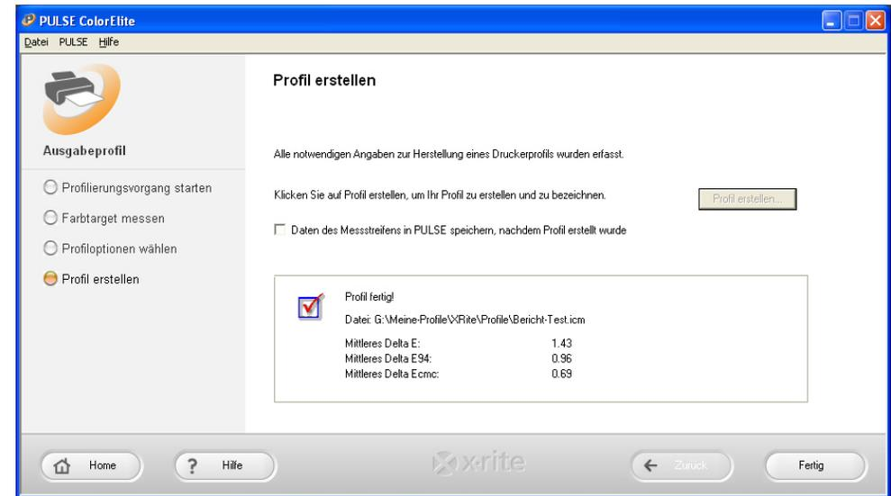
④ Zum Abschluss der Berechnung wird eine kurze (für meinen Geschmack zu kurze) Fehlerstatistik zur Beurteilung der Qualität des Profils ausgegeben. Das Profil kann nun benutzt werden.
