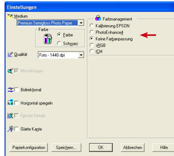
⑤ Mit „Keine Farbanpassung“ wird das Farbmanagement im Druckertreiber ausgeschaltet. Bei anderen Druckern sehen die Einstellungen natürlich etwas unterschiedlich aus. Die benutzten Einstellungen muss man sich notieren, da mit diesen Einstellungen auch später mit dem erzeugten Profil gedruckt wird.
