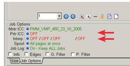
⑦ ▲ In Qimage wird für den Druck des Targets das Farbmanagement, sowie Interpolation/Schärfung ausgeschaltet.
