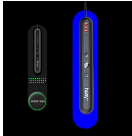
③ Das Paket schickt eine Sequenz unterschiedlicher bekannter Farbwerte auf den Monitor und misst mit dem Colorimeter deren Bildschirmdarstellung.
