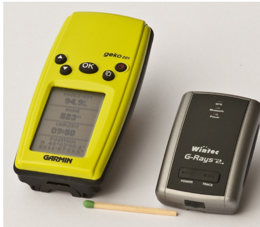
Abb. 4: Zwei typische GPS-Logger: links ein Allzweck-GPS mit Display (Garmin geko 201), rechts ein reiner Logger speziell für Foto-Zwecke (Wintec WBT-201).
