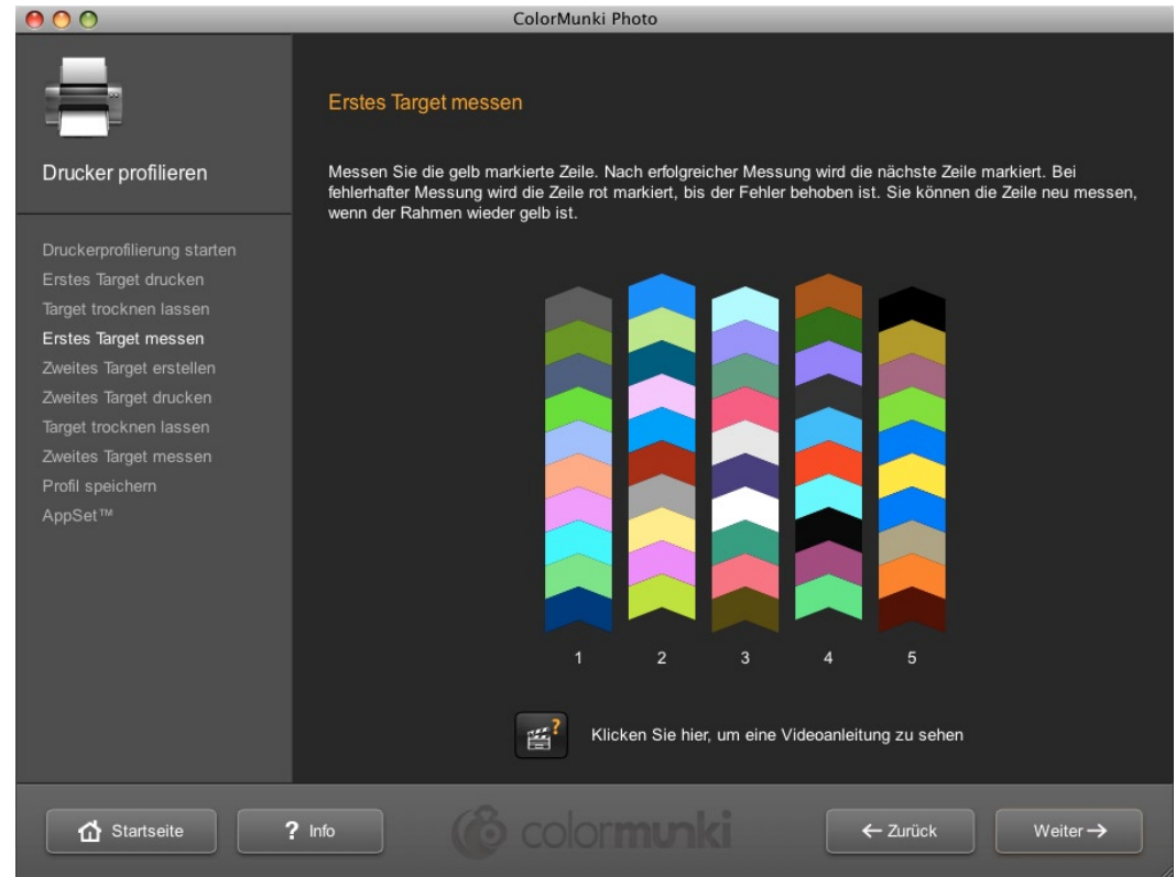
Abb. 3: Nach dem Countdown der Trockenzeit werden die Teststreifen des ersten Blatts vermessen.
