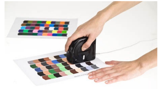
Abb. 4: Die Streifen lassen sich auch ohne Lineal zügig und sicher vermessen
