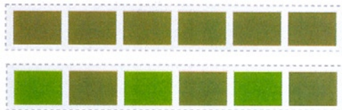
Abb. 8: D50-Qualitätstest mit einem Teststreifen von Quato. Im oberen Beispiel ist das Licht in Ordnung, beim unteren Test nicht.
