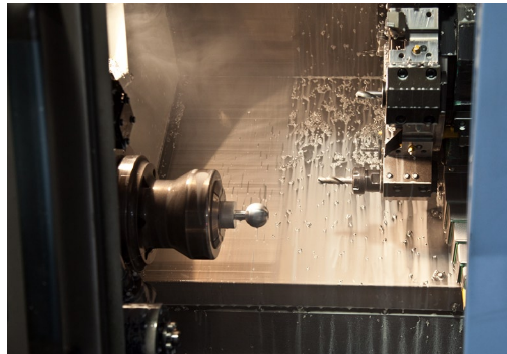
Abb. 10: Die Kugelhöpfe werden nicht gegossen, sondern aus dem Vollen mit hochmodernen Maschinen gefräst.
