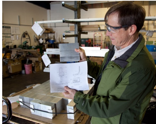
Abb. 6: Aus diesem 7 Pfund schweren Aluminiumquader entstehen zwei 150 Gramm schwere L-Plates.
