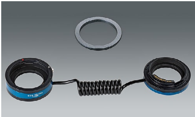
Abb. 17: Bei diesem Retroadapter-Kupplungsset von Novoflex [3] werden die Steuerdaten der Kamera vom Ring zwischen Kamera und umgekehrtem Objektiv elektronisch an den zweiten Adapter übertragen, der vorne am Objektivbajonett sitzt. Dies erlaubt z.B. die Blendensteuerung durch die Kamera.
