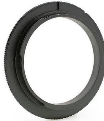
Abb. 15: Der Retroadapter hat auf der einen Seite den Anschluss für das Kamerabajonett und auf der anderen ein Gewinde, das man in das Filtergewinde des Objektivs schraubt.
