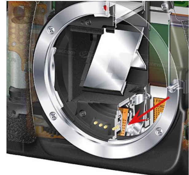
Abb. 3: Anbringung des Autofokus-Sensors (roter Pfeil) in einer Canon 5D, Abbildung nach Canon, USA
