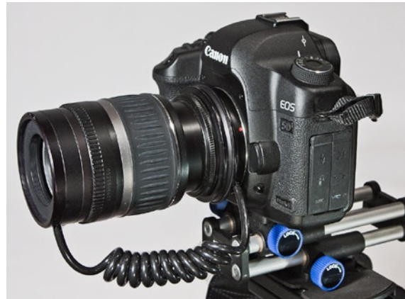
Abb. 18: Canon Kit-Zoom (18–55 mm) per Novoflex-Retroadapter an einer Canon 5D. Zum Fokussieren sitzt die Kamera auf einer Makroschiene.
