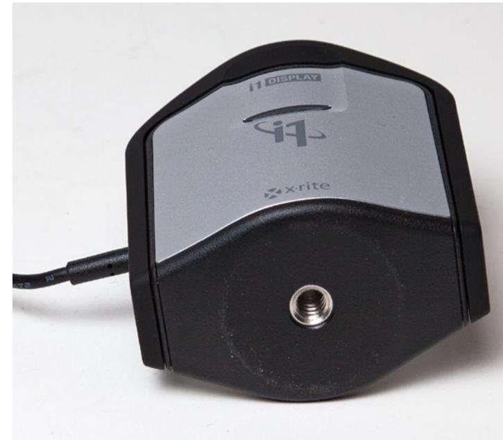
Abb. 13: Mit dem Gewinde unten am i1Display pro kann man beim Profilieren von Projektoren das Gerät auf ein Fotostativ stellen.
