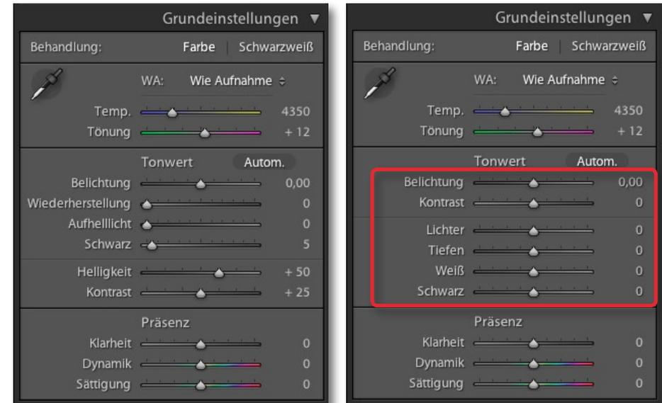
Abb. 3: Die markierten Regler ändern sich mit der Prozess-Version (links: 2003/2010, rechts: 2012).
