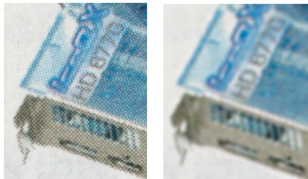
Abb. 10: Bildausschnitt – links ohne, rechts mit Enrasterung
