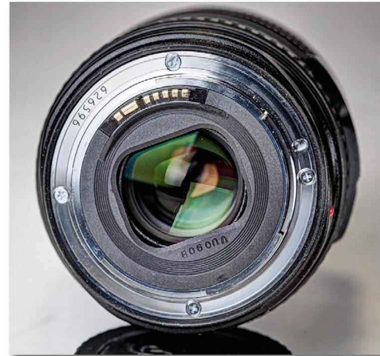
Abb. 3: Der Objektivanschluss und die hintere Linse erfordern besondere Sorgfalt beim Reinigen. Schmutz und Kratzer auf der hinteren Linse sind eher als bei der Frontlinse im Bild sichtbar. Die elektronischen Objektivkontakte sollten möglichst kein Hautfett von den Fingern abbekommen.
