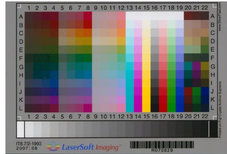
Abb. 11: Das SilverFast IT8-Target mit Barcode ermöglicht eine sehr einfache Profilerstellung für den Scanner.
