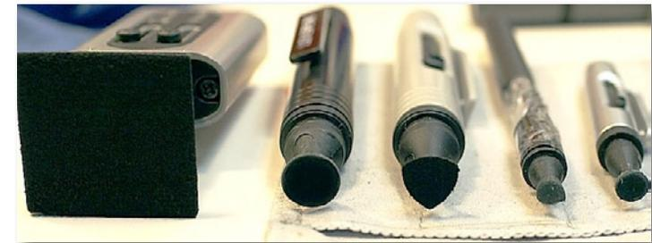
Abb. 2: Eine Auswahl an Reinigungsstiften verschiedener Art und Größe. Links der Laptop-Stift, der sich besonders für Supertele- Frontlinsen eignet. Beachten Sie die beiden Exemplare rechts: Wenn die Stifte so aussehen, sollte man sie langsam entsorgen. Auch der direkt neben dem Laptop-Stift ist bald fällig. Wenn man Gummi statt Stoff am Rand sieht, ist der Stift verbraucht.
