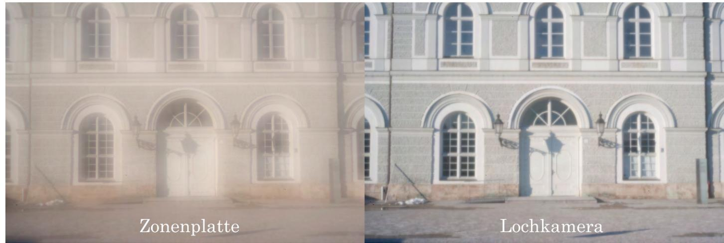
Abb. 6: Vergleich Zonenplatte (links) und Lochkamera (rechts)
