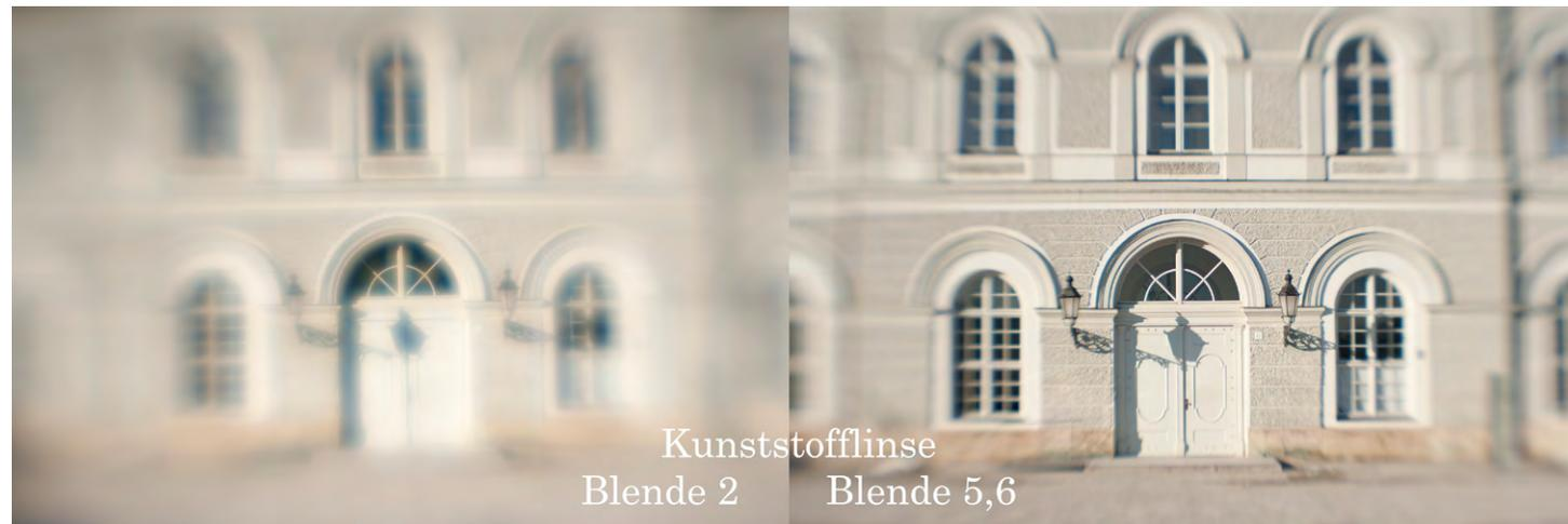
Abb. 5: Blendenvergleich Kunststofflinse: links bei Blende 2,0, rechts bei Blende 5,6
