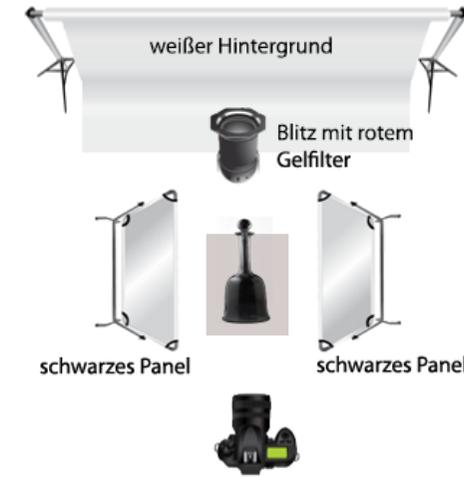
Belichtungsdiagramm, erstellt mit der ›Strobox‹-App auf dem iPad
