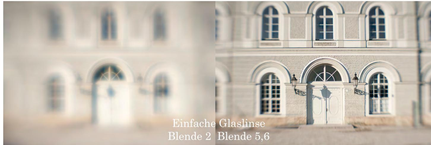
Abb. 4: Blendenvergleich einfache Glaslinse: links bei Blende 2,0, rechts bei Blende 5,6
