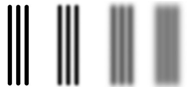
Abb. 7: Um Bildelemente – hier Linien – unterscheiden zu können, bedarf es ausreichend Kontrast. Die Beugung arbeitet dagegen und erzeugt Unschärfe.
