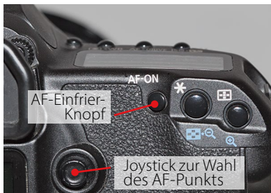
Abb. 4: Bei einigen Canon-Kameras findet man hier zwei wichtige Knöpfe für den Autofokus.
