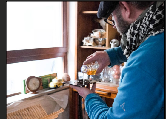
Abb. 4: Auftragen von Firnis (Mischung aus Gum Sandarac, Lavendelöl gelöst in Alkohol) zum Versiegeln der Nassplatte
