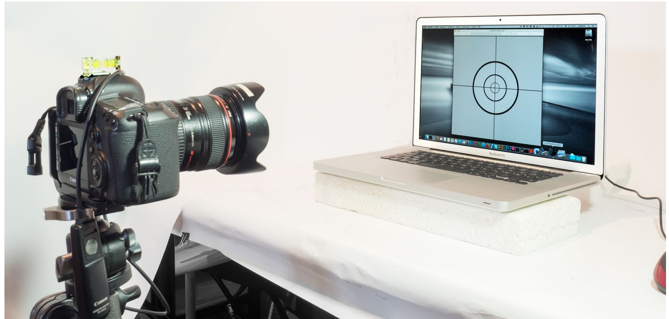
Abb. 1: Mein Set-up von Kamera, aufgesetzter kleiner Wasserwaage oben (zum horizontalen Ausrichten) und Kabelauslöser auf Stativ. Für den eigentlichen Test habe ich mit gedämpftem Licht gearbeitet.
