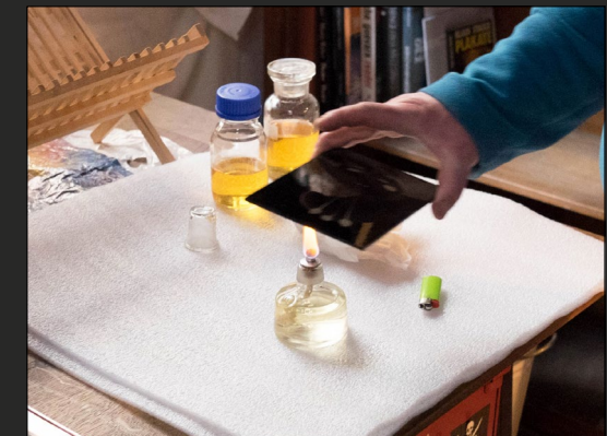
Abb. 5: Erhitzen und Einbrennen der Firnis auf der Platte
