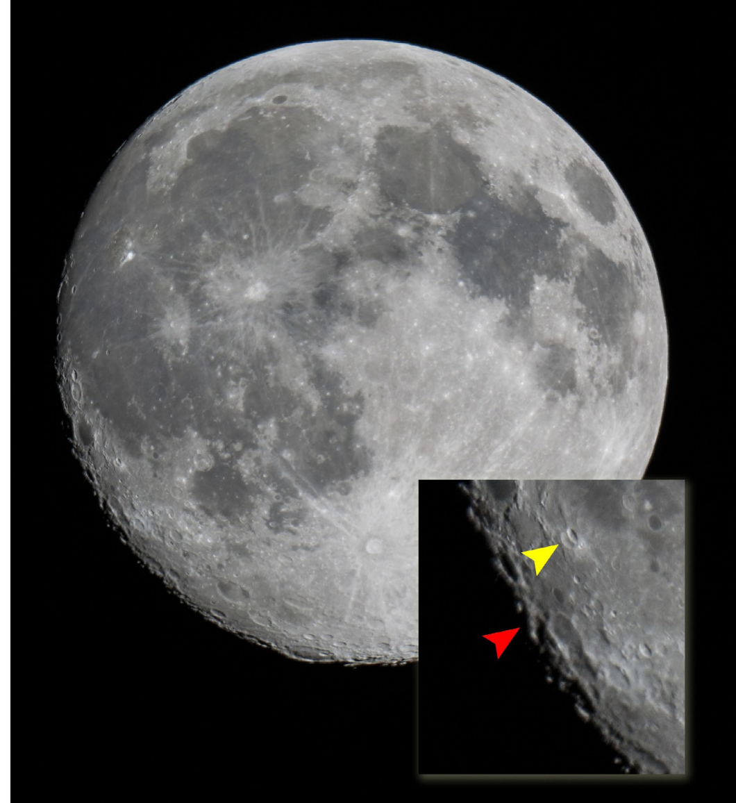
Abb. 3: Mond: Einzelaufnahme mit Spiegelteleskop und DSLR-Kamera. Der Ausschnitt rechts zeigt vergrößert die sichtbare Tag-Nacht-Grenze (Terminator). Gelber Pfeil: Scharfes Bilddetail. Roter Pfeil: Unscharfes Detail, verursacht durch Luftverwirbelung. Teleskop: Newton 200/1.000, Montierung: EQ5, Kamera: Canon 1000D, Belichtungszeit: 1 x 1/200, ISO 100.
