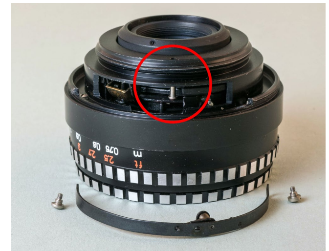
Abb. 5: Wenn bei offener Blende Teile der Lamellenkanten im Strahlengang sichtbar bleiben, liegt es meistens am Kamera-Adapter. Man kneift den Blendenstift ab oder löst die hintere Abdeckung, schraubt den Bügel los und entnimmt den Stift.
