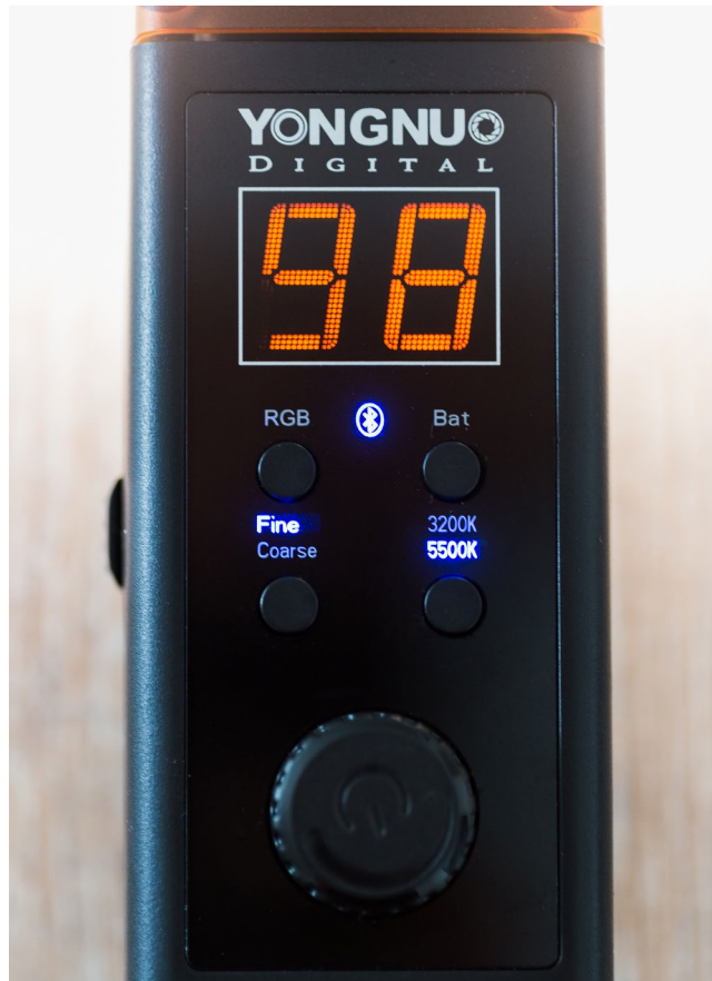
Abb. 6: Die Bedienelemente des YN360
