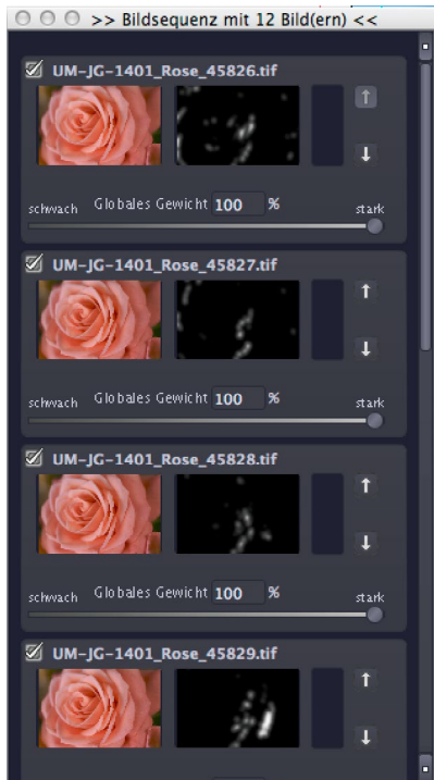
Abb. 6: Leiste mit den einzelnen Quellbildern, dem Gewichtsregler darunter sowie der Maske (hier als Gewichtungsmatrix bezeichnet).
