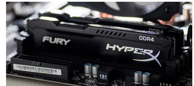
Abb. 3: Oben: So sah vor langer Zeit einmal der Hauptspeicher aus – ein sogenannter Kernspeicher, bei dem jeder der kleinen Magnetkerne ein Bit speicherten. Unten: So sehen heutige Speicherriegel aus – hier zwei 8-GB-DDR4-Riegel bereits in den Slots des Mainboards.
