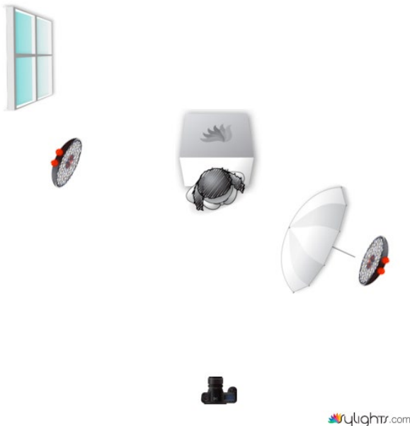
Abb. 3: Das symbolische Setup zeigt den Aufbau aus zwei Neos in zwei Schirmen. Hinten ist das Dachflächenfenster erkennbar.
