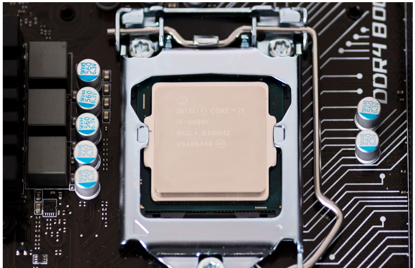
Abb. 2: Die CPU ist das Herz des Rechners – hier ein Intel Skylake i5 6600K mit 3,5 GHz Takt und vier Kernen
