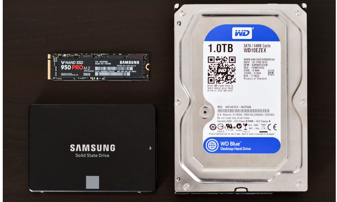
Abb. 5: Während HDDs (rechts im Bild) für das Speichern von Daten nach wie vor das beste Preis-Leistungs-Verhältnis bieten, sind S-ATA-SSDs kleiner, schneller und dabei sogar völlig lautlos. Noch schneller als S-ATA-SSDs sind NVMe-SSD-Riegel (links oben).
