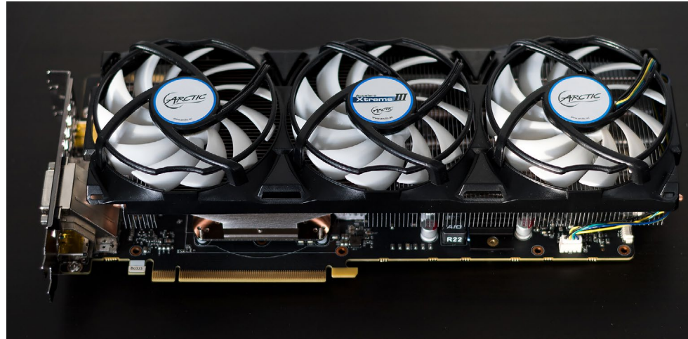
Abb. 4: Eine aktuelle NVIDIA GTX 1080 mit 8 GB VRAM ist derzeit mit das Schnellste, was es im Consumerbereich gibt – für die Bildbearbeitung ist sie allerdings überdimensioniert. Eine kleinere und energie-sparendere Karte mit 4 GB VRAM ist absolut ausreichend und kostet nur ein Drittel.
