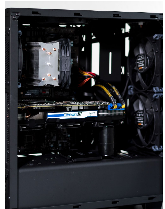
Abb. 4: Kabelmanagement schafft Übersicht im Gehäuse und ermöglicht eine effizientere Luftzirkulation zur Kühlung der Komponenten.
