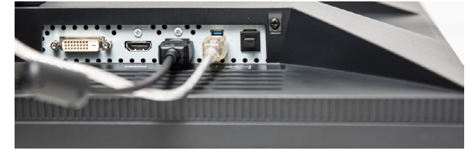
Abb. 5: Die drei Display-Schnittstellen – DVI, HDMI, Display-Port – und ganz rechts die USB-Schnittstelle für den USB-Port. Die drei USB-Anschlüsse liegen hinten seitlich und sind so gut zu erreichen.
