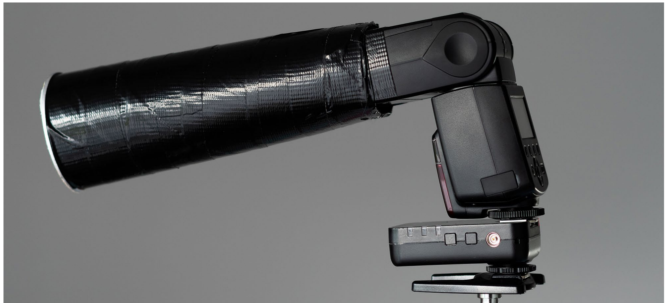
Abb. 7: Der fertige Snoot mit Grid am Blitzgerät angebracht
