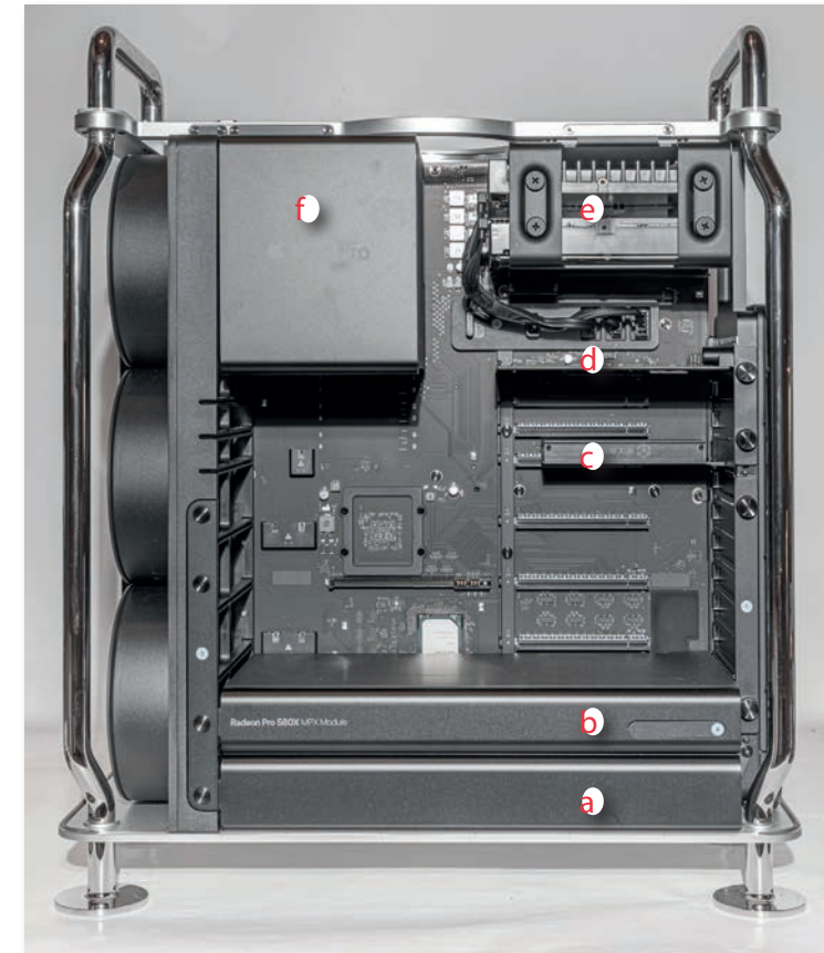
Abb. 8: Blick in das Innenleben von der rechten Seite: Ganz unten sitzt das als Modul tauschbare Netzteil A, darüber die Radion Pro 580X-Grafikkarte B. C ist eine von mir installierte PCIe-Adapterkarte mit einer schnellen M.2 NVME-SSD mit Kühlkörper. Darüber steckt die IO-Karte D. Oben sieht man die Promise J2i-Einheit E mit der 8 TB HD und einer zusätzlich installierten 4 TB SATA-SSD. Die Anschlüsse für die Strom- und SATA-Kabel zu deren Versorgung sieht man darunter (für Details siehe Abb. 9)
