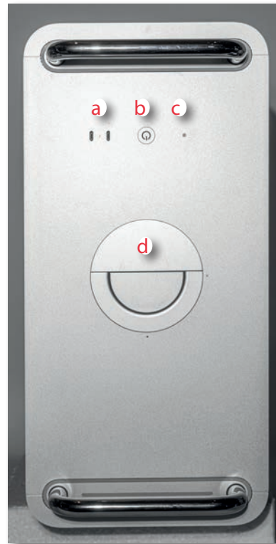
Abb. 7: Blick von oben: A sind die zwei oberen Thunderbolt-3-Anschlüsse (Typ C), der Ein-/Ausschalter B sowie die LED C. D ist der große Griff, mit dem man das Gehäuse (nach einer 90°-Drehung) abziehen und auch wieder verriegeln kann. Beim Abziehen ist der Rechner stromlos (die hinteren Kabel müssen dafür zuvor abgezogen werden).
