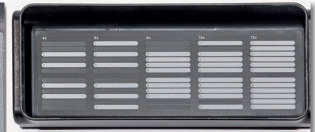
Abb. 3: In der Abdeckung für die Speicherriegel wird das Schema für die Bestückung gezeigt.
