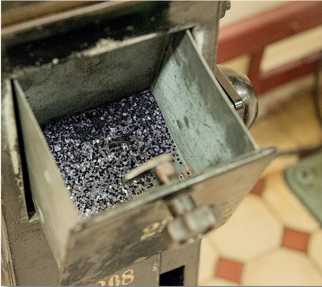
Abb. 4: Die Filmperforation für Kleinbildfilme wird eingestanz. Bis zu 20 Maschinen lärmten lautstark bei absoluter Dunkelheit im Drei-Schicht-Betrieb vor sich hin.
