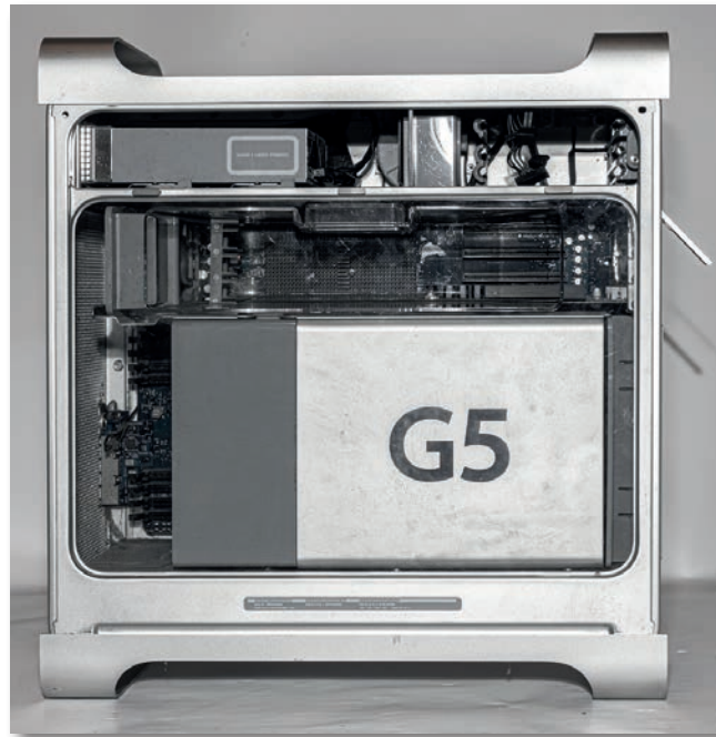
Abb. 15: Ein Blick in das Innenleben des alten G5 – eines Mac Pros früherer Generationen. Oben rechts saßen die zwei Festplattenlaufwerke und links der integrierte CD-Brenner. Ein (hier aufgesetztes) großes Plexiglas-Element unterstützt die Luftführung.
