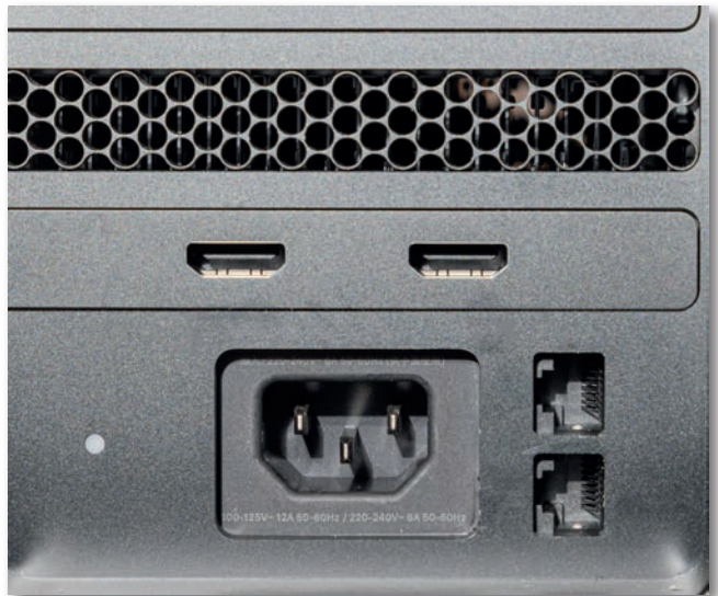
Abb. 5: Auf der Rückseite sitzt unten der 220 Volt Anschluss, daneben die zwei RJ45 Buchsen für die 10 GBit LANs und bei der Radion Pro 580X darüber die zwei HDMI-Anschlüsse.
