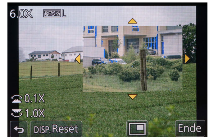
Abb. 6: Panasonic-Kameras bieten Ausschnittvergrößerungen und viele Informationen zur Bedienung. Oben links werden Vergrößerung (6.0x) und Fokuspeaking-Level (Low) angezeigt.
