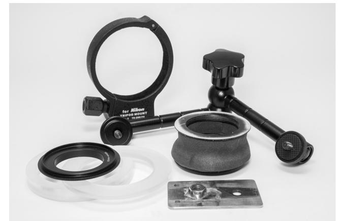
Abb. 8: Der Gelenkarm soll die Objektivschnelle über die Metallplatte (vorne) mit einem L-Bracket verbinden. Ein M42-Adapter fungiert mit Moosgummi und einem Filterring verklebt als Objektivträger. Der Umkehring (links) stellt den Anschluss zur Kamera her.
