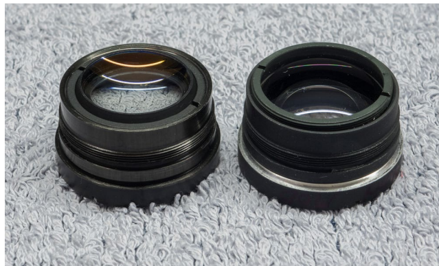
Abb. 5: Links ein Linsenblock im Originalzustand, rechts modifiziert mit umgedreht montierter Linse
