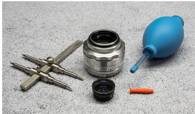
Abb. 4: Der hintere Linsenblock – hier vorne im Bild – lässt sich oft ohne Werkzeug herausschrauben.
