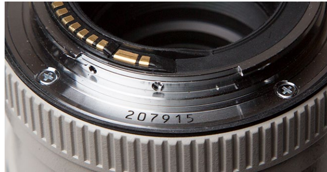
Abb. 1 Hier ist die Seriennummer des Objektivs innen im Bajonettring eingeprägt.
