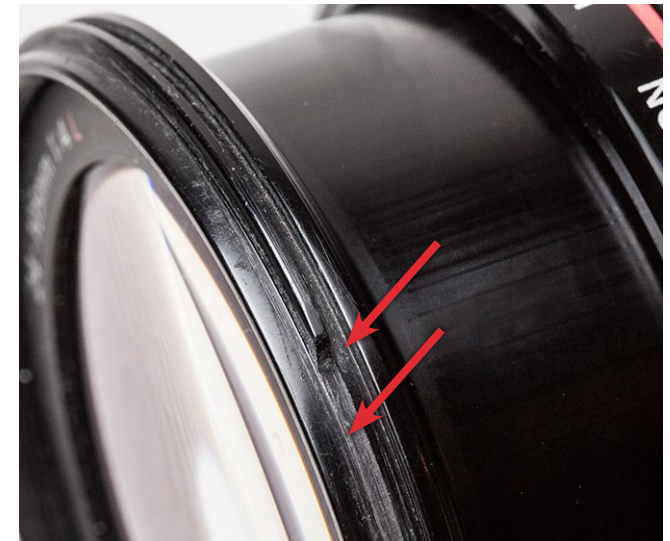
Abb. 5 Hier sitzen gerne Staub und Sand und haben bereits Schleifspuren beim Aufsetzen der Sonnenblende hinterlassen.
