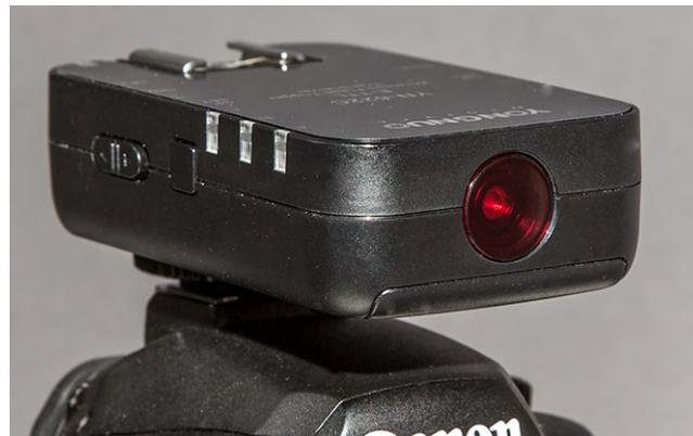
Abb. 4: Der Transmitter hat vorne ein rotes Hilfslicht. Es erleichtert bei schwachem Licht das Fokussieren.
