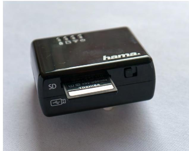
Abb. 6 Mit einem WiFi-Kartenleser in Kombination mit einem CF-Kartenleser gelingt sogar die drahtlose Datenübertragung von CF-Karten.
