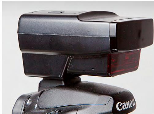
Abb. 5: Beim Canon E-TTL-System lässt sich der Speedlite Transmitter ST-E2 als Master einsetzen. Er ›blitzt‹ selbst nicht, sondern schickt die Kommandos nur per Infrarotlicht zu den Slave-Blitzen.
