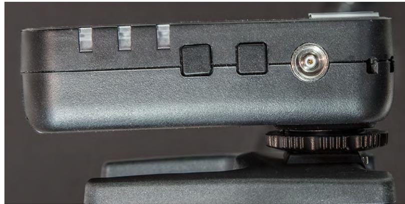
Abb. 2: Seitenansicht mit Blick auf den Fuß (hier in einer Blitzfußhalterung) und die PC-Sync-Buchse, an die man z. B. einen Studioblitz oder einen nicht Canon-konformen Blitz anschließen kann.
