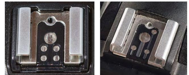
Abb. 2: Links ein aktueller Canon-Blitzschuh mit seinen fünf Kontakten, rechts ein Nikon-Blitzschuh mit vier Kontakten, aber an anderer Stelle und mit etwas anderen Funktionen. Nur der größere Mittelkontakt (zum reinen Auslösen) ist identisch.
