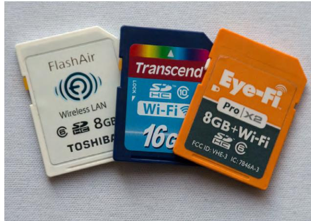
Abb. 1: SD-Karten mit WLAN-Modul sind mittlerweile von verschiedenen Herstellern erhältlich
