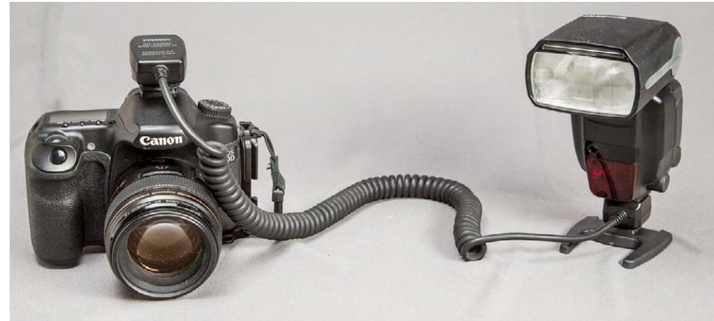
Abb. 1: Blitzkabel, welches die Kommunikation zwischen Kamera und Blitz überträgt
