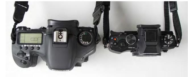
Abb. 1 Der Vergleich zwischen einer Canon EOS 7D (links, ca. 915 Gramm mit Akku) und der Olympus OM-D (ca. 425 Gramm mit Akku) zeigt den doch gewaltigen Größenunterschied zwischen einer Spiegelreflexkamera und einer spiegellosen Systemkamera. Durch den Wegfall des Spiegels fallen die Systemkameras deutlich ›dünner‹ aus.
