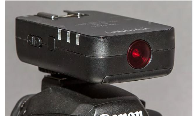
Abb. 1: Der Transmitter (YN-622C) hat vorne ein rotes Fokussierlicht. Es erleichtert bei schwachem Licht das Scharfstellen.
