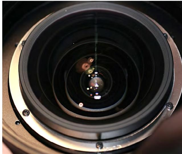
Abb. 7: Löst man den Aluminiumring, so kann man das Linsenelement leicht verschieben, um es zu zentrieren.
