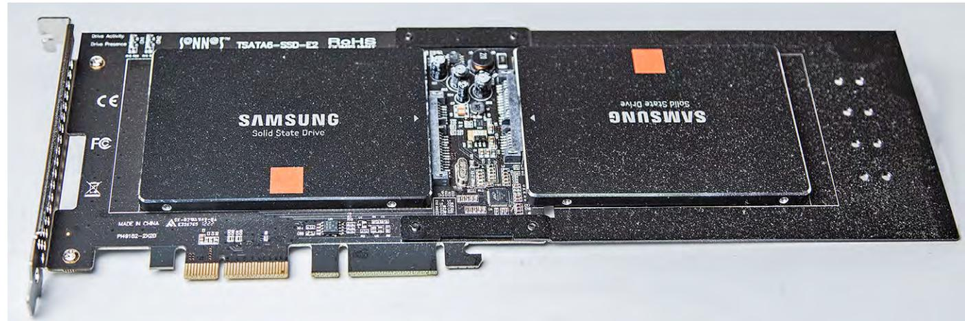
Abb. 7: Man sieht rechts die aufgeschraubte Kartenverlängerung sowie die zwei aufgesteckten Samsung-840-SSD-Module.
