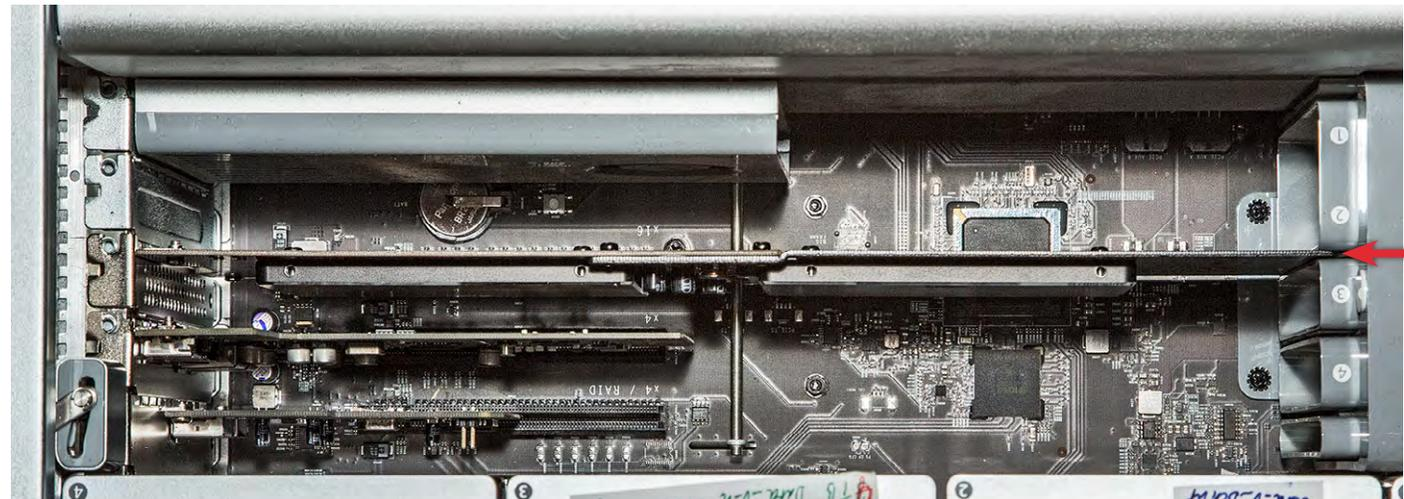
Abb. 8: Eingebaut im Mac Pro. Zum Einbau muss man rechts den Ventilatorschacht zurück- und später wieder vorziehen.
