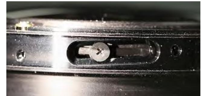
Abb. 5: Ein Element ist auf einer Art »Rampe« angebracht, so dass sich durch Öffnen der Schraube und Verschieben auf dieser Rampe der Abstand zwischen dem optischen Element und den benachbarten Elementen verändern lässt.
