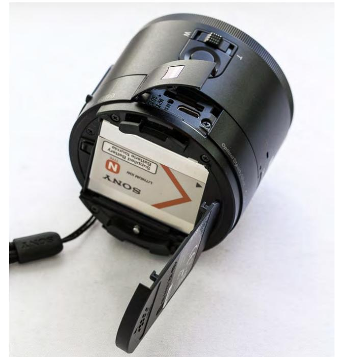
Abb. 4: Die Detailaufnahme zeigt die Bedienelemente und Klappen der QX100.
