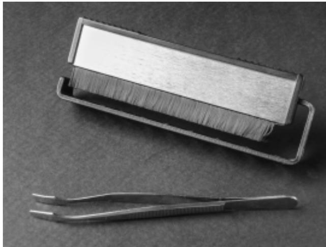
Abb. 11: Antistatikbürste für analoge Schallplatten und Briefmarken-Pinzette mit gebogenen Schaufeln bewähren sich beim Negativ-Handling. Ein zusätzlicher Blasebalg, wie zur Sensorreinigung verwendet, erledigt den Rest.
