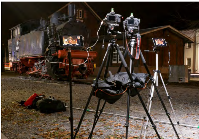
Abb. 4: Die Kamera auf dem beschwerten Stativ ist per USB-Kabel mit dem Tablet verbunden und wird von der dort laufenden App gesteuert.
