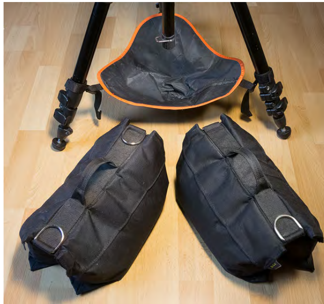
Abb. 3 Der »Steinbeutel« zwischen den Stativbeinen wird mit Sandsäcken beschwert und sorgt so für ein nicht wackelndes Stativ.
