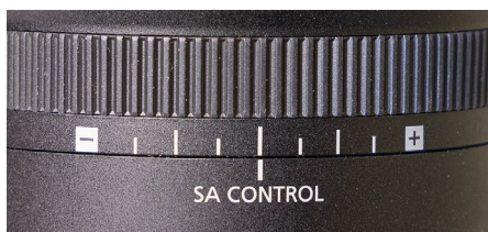
[5] Im Standardfall steht SA Control auf Null (in der Mitte). Mit negativen Werten wird primär das Bokeh vor der Schärfenebene verstärkt, mit positiven Werten dahinter.
