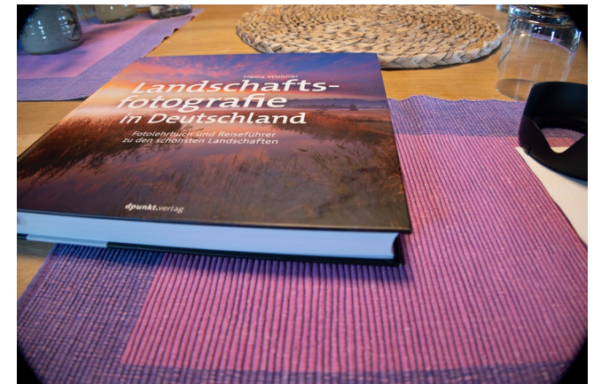
[1] Unkorrigiert weist das Canon RF 24–240 mm im Weitwinkelbereich erhebliche Randabschattungen (Vignettierung) auf.
