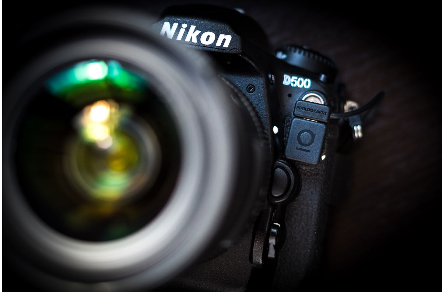
Abb. 1: Beim Foolography Unleashed handelt es sich um ein winziges Bluetooth-Modul, mit dem sich die Kamera via App am Smartphone oder Tablet steuern lässt.
