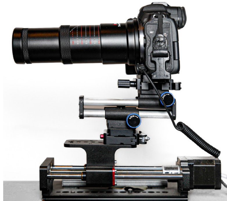
[5] Für größere Fokus-Serien habe ich den elektronisch gesteuerten Makroschlitten der chinesischen Firma WeMakro verwendet. Er erlaubt sehr präzise und auch sehr kleine Schritte (z. B. 0,001 mm) – auch in größerer Anzahl.
