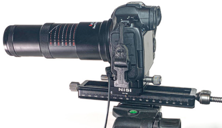
[4] Für ein möglichst präzises Fokussieren über die Abstandsänderung zum Motiv habe ich hier eine manuelle Makroschiene der Firma NiSi eingesetzt.
